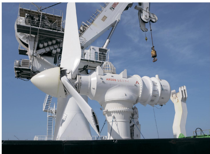
潮流発電機「なるみらい」
