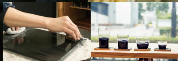
左／「研ぎ」と呼ばれる工程。漆を塗った後の製品に紙やすりをかけ、面を平らにして次の工程に備える 右／日常使いをコンセプトに掲げた「TOUCH CLASSIC」シリーズ
