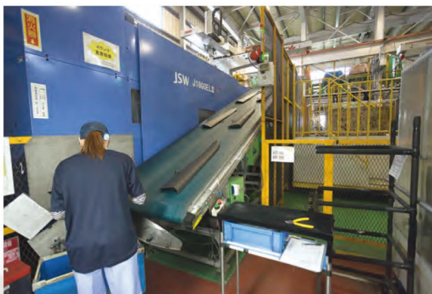
樹脂を加工する機械から出てきたばかりの自動車部品
