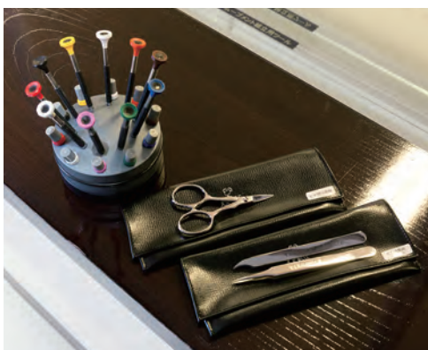
左/ムーブメントの組み立てに使う道具。ピンセットなど様々な道具を駆使して組み上げる 中/金属の棒や板を削り出し、時計の部品をつくり出す「自動旋盤」と呼ばれる作業 右上/高級機械式腕時計は、ペン先よりも細い非常に小さな部品からつくられる 右下/時計内部の基盤となる部品。さらにこの上に様々な部品が組み上げられていく
