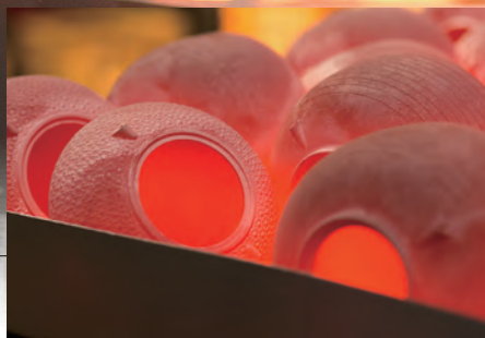
“上等焼”の工程を終えたばかりの鉄器。ものすごい熱を放っている
