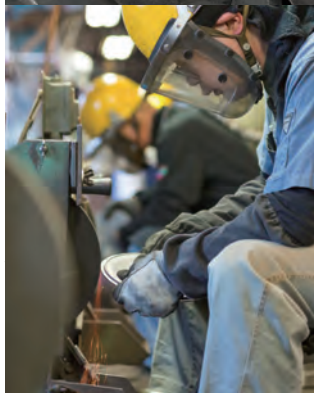
上／鑄型から取り出したばかりの鉄器。この後に研磨作業を行っていく 左下／鉄器の研磨作業の様子。不要な突起などを取り、滑らかな表面に仕上げる 右下／鉄器の原料となる「銑鉄」
