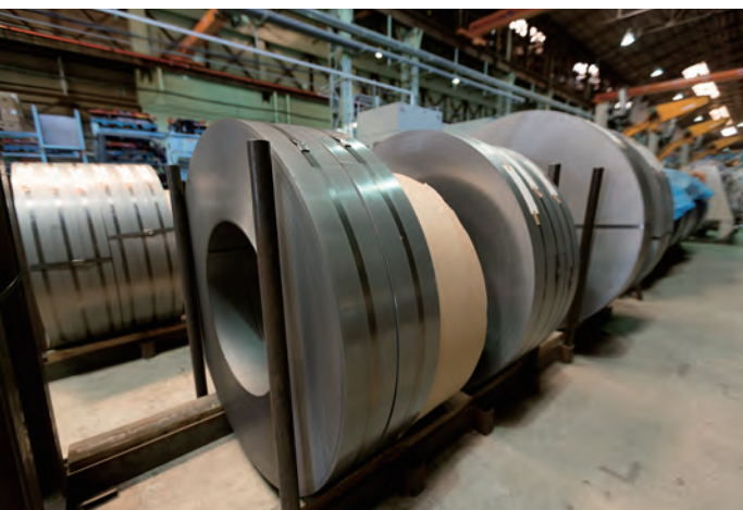
製品に加工される前の薄引き伸ばされた鉄板。これらをプレス・塗装して製品に仕上げる
