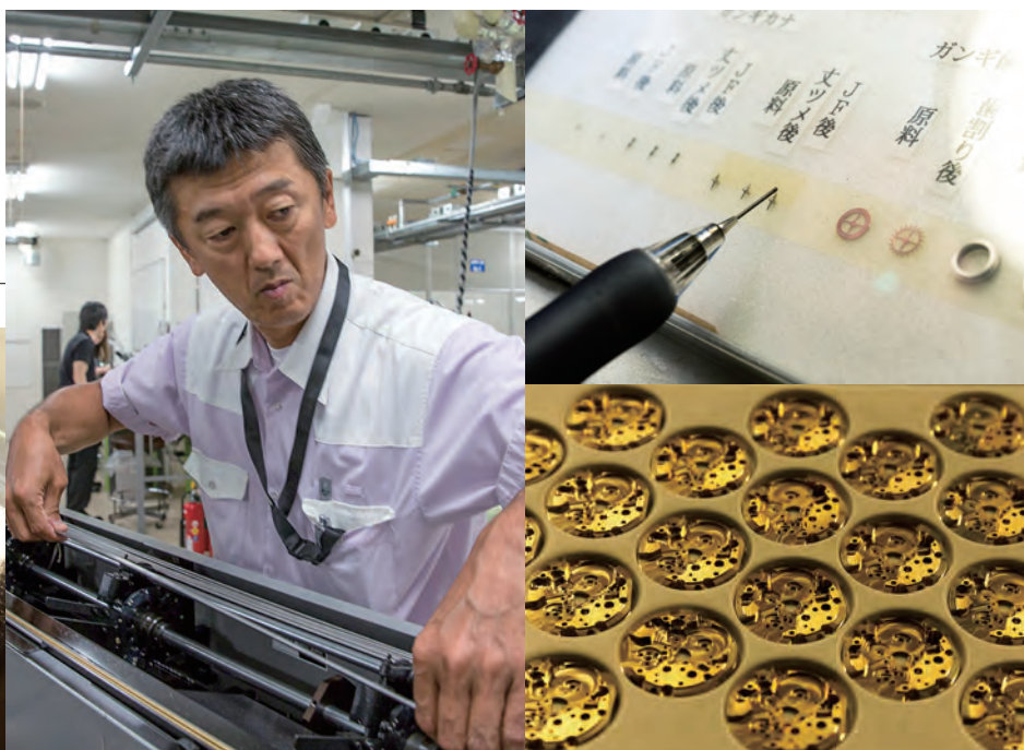
左/ムーブメントの組み立てに使う道具。ピンセットなど様々な道具を駆使して組み上げる 中/金属の棒や板を削り出し、時計の部品をつくり出す「自動旋盤」と呼ばれる作業 右上/高級機械式腕時計は、ペン先よりも細い非常に小さな部品からつくられる 右下/時計内部の基盤となる部品。さらにこの上に様々な部品が組み上げられていく
