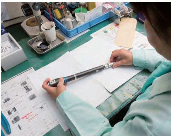
防水マイクの組み立て作業。50以上の部品を組み上げる
