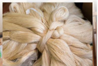
繭を煮てほぐし、真綿にしてから手で糸を紡いだ真綿手紡糸
