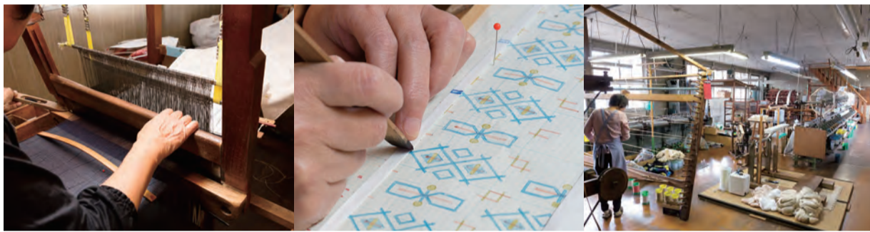
左/塩沢紬の織り上げ作業。湿度などにより日々状態が違い、それを踏まえた作業を行う必要があるためベテランでも1日50分程度しか織ることができない 中/頭の中にある色や模様を方眼紙に落とし込む。いわば塩沢紬の設計図だ 右/この工房で職人が糸づくりから織り上げまでの作業を一貫して行い塩沢紬を生み出している
