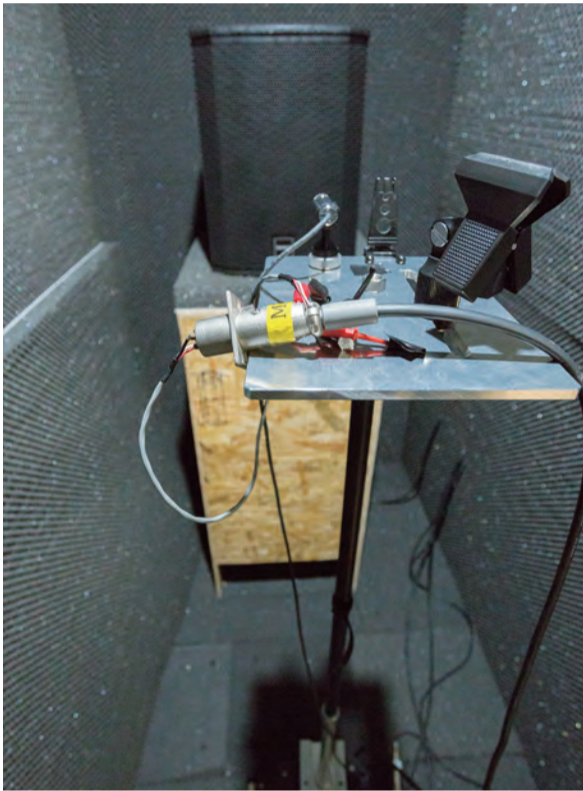
製品試験に使用している音響室。これ以外にもダムや海で試験を行っている
