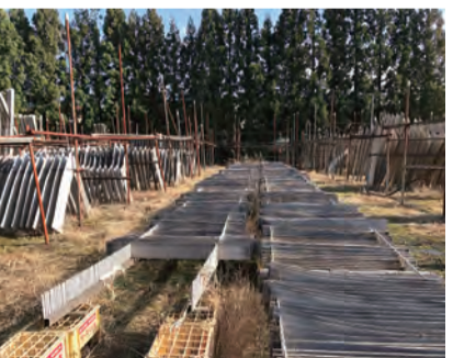
右/桐の板は薄くても1年、厚ければ3年もの期間干し続ける。天日に当て、雨風にさらすことで洗抜きし、桐箆筒に使えるものに仕上げる
