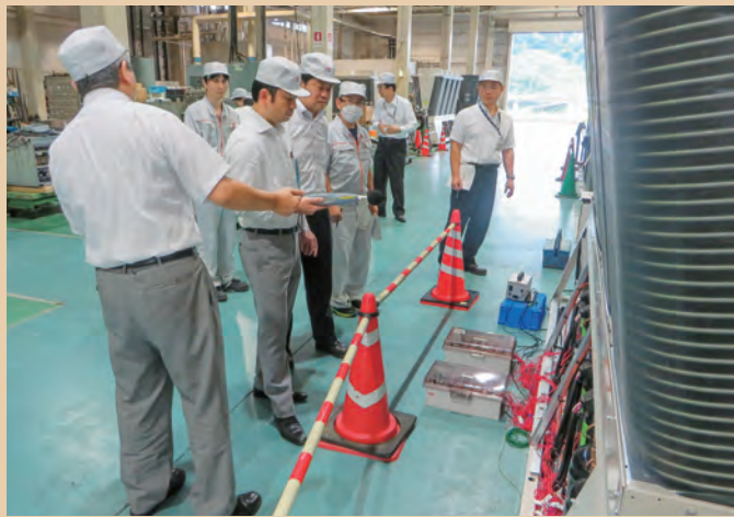
東芝キャリアの工場においてヒートエッジの加熱性能の確認を行っている様子
