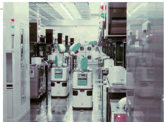
クリーンルーム内で半導体の製造を行うロボット
