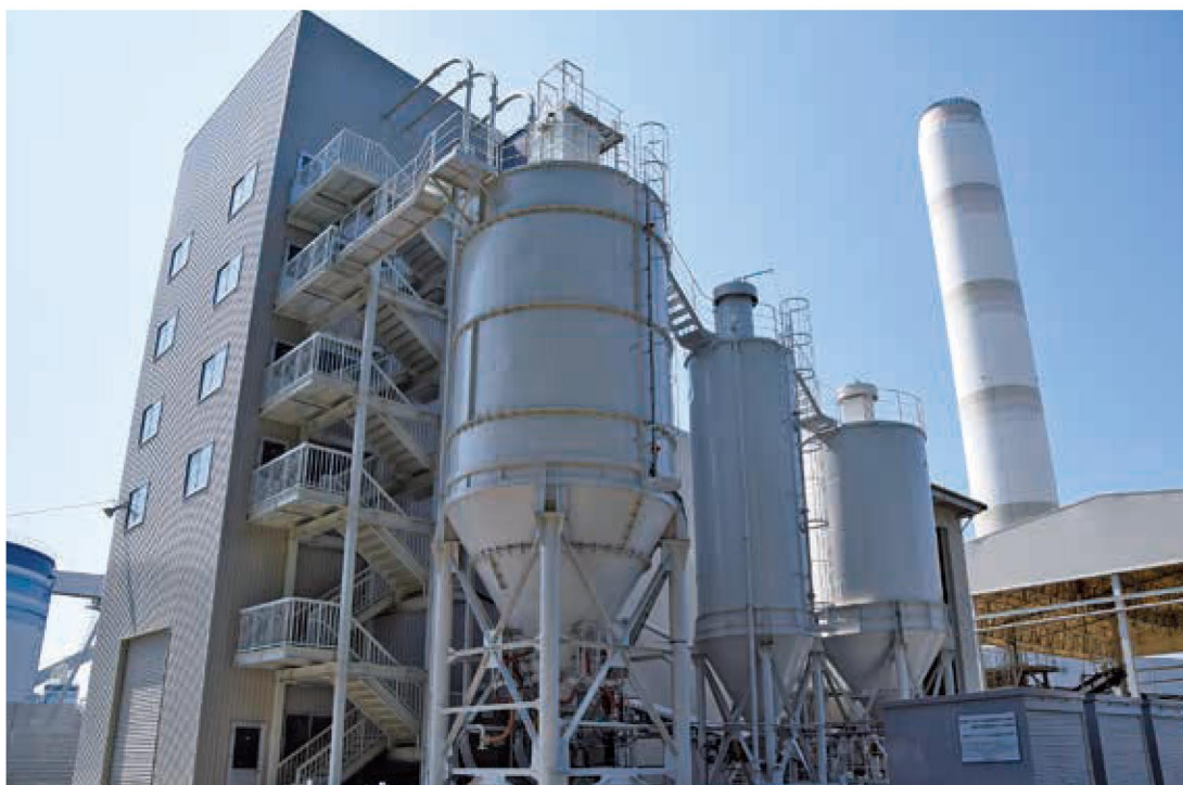
造粒物を成形する混合・造粒設備
