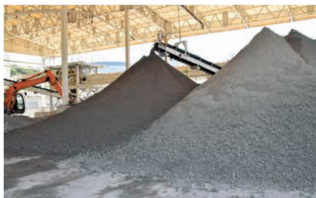
初期養生ヤードに保管された造粒物
