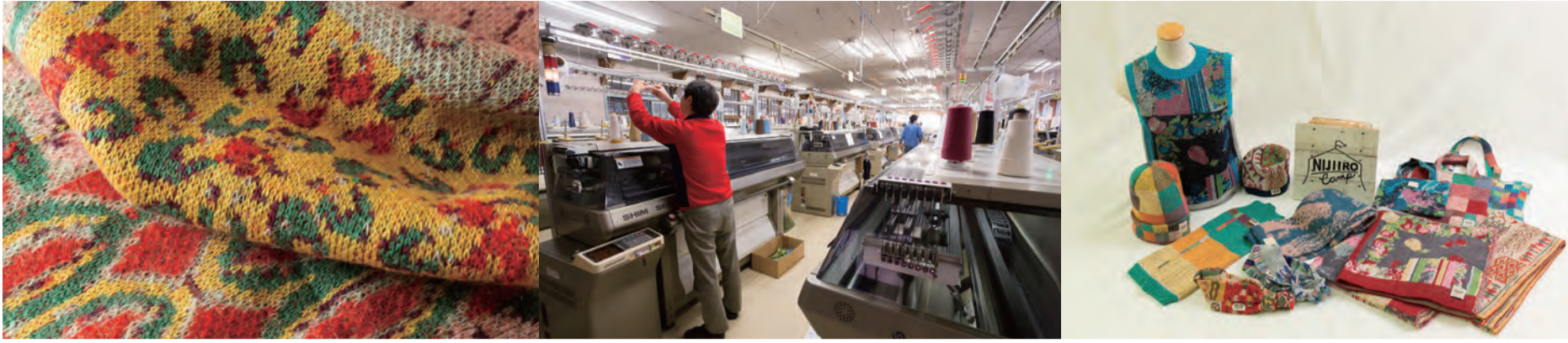
左／新ブランド「NIJIRO Camp」の柄。動植物や幾何学模様など、複雑で多彩な色合いの柄を表現する 中／コンピューター式の編み機。デザインシステムも導入し、ソフトウェア上で、デザイナーが描いた柄を微細なドット(編み目)に写し込んで編む 右／「NIJIRO Camp」のラインアップ。秋冬向けにニット帽やマフラー、バッグ、ベストなどを販売。2017年の春夏物では、丈夫で軽やかな和紙を織り込んだニット帽も開発した
