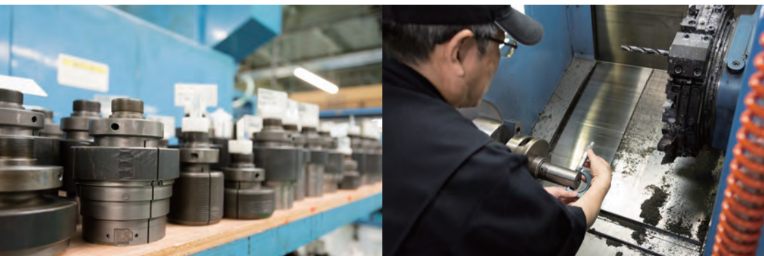
左/レンズ部品の精密な組み立てを実現するために必要な加工の元となる治具。ネジ穴をあけるドリルの研磨に至るまで、シグマは自社で行っている 右/治具の削り出し工程。精密な部品を加工するためには精密な治具の存在が不可欠。試作治具加工部は工場内でもまさに職人技が生きる部門だ
